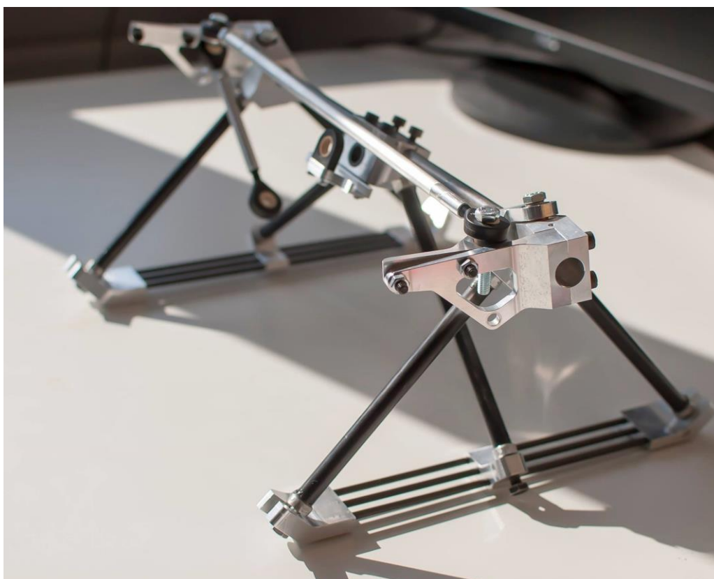
Przednie zawieszenie wykonane z frezowanego aluminium i bardzo wytrzymałych rurek węglowych; Całość waży zaledwie 800g
