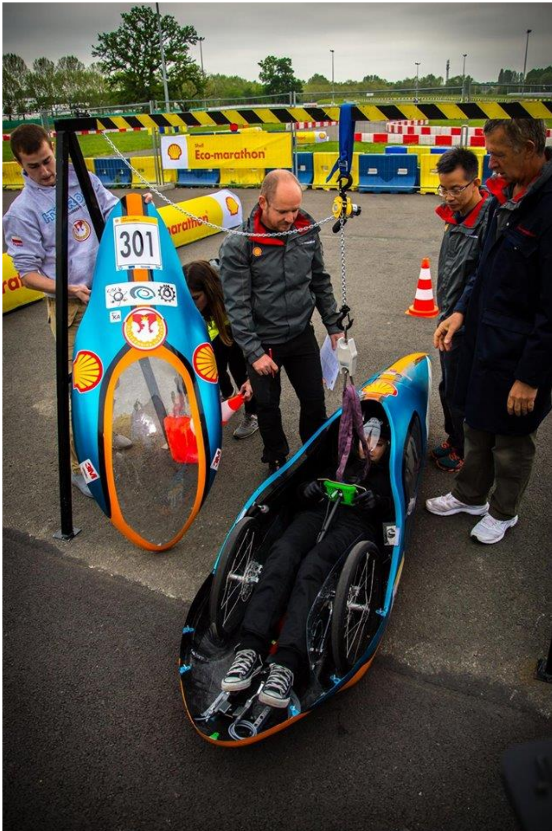
Test sprawdzający pasy bezpieczeństwa. Musiały wytrzymać podniesienie pojazdy wraz z kierowcą
